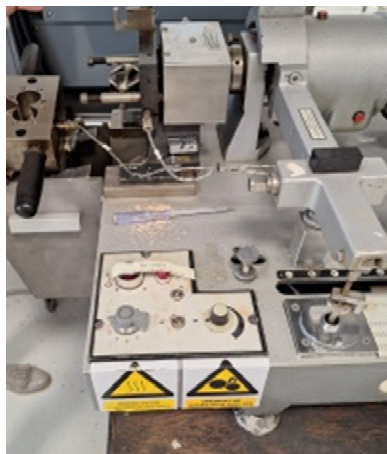
Slika 11. Uređaj s mehaničkim i toplinskim opasnostima
